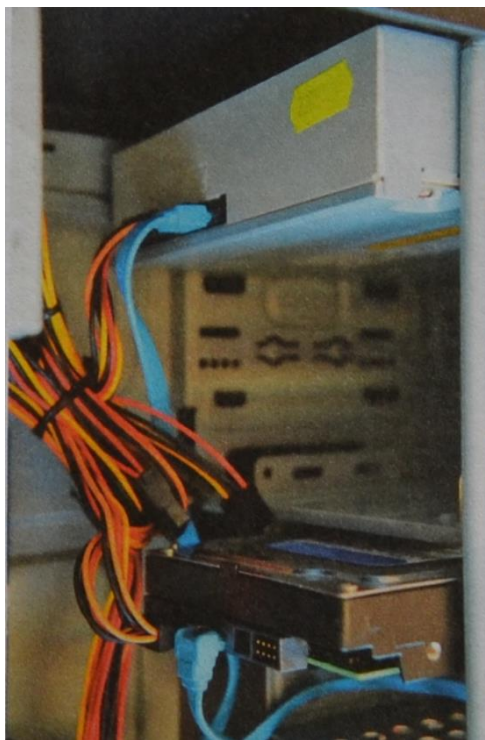
Rys. 42.17. Podłączenie napędów pamięci masowej
