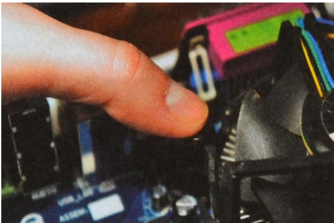
Rys. 42.6. Montaż coolera
