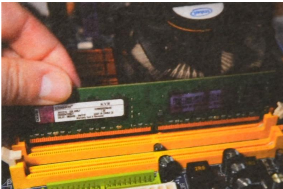
Rys. 42.8. Ustalenie położenia modułu pamięci
