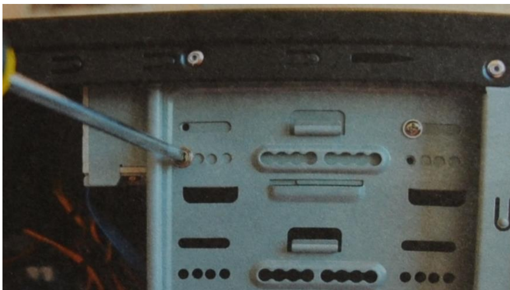
Rys. 42.16. Montaż napędu optycznego
